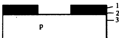
4.16-rasm. Yorug'lik bilan yoritish va yedirish natijasida \text{SiO}_2 qatlamda ochilgan "darcha": 1 – fotorezist; 2 - \text{SiO}_2 qatlami; 3 – yarimo'tkazgichli plastinka.
