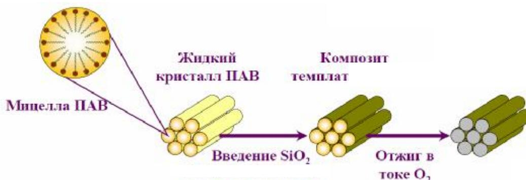
Рис. П.9. Схема синтеза мезопористого оксида кремния
