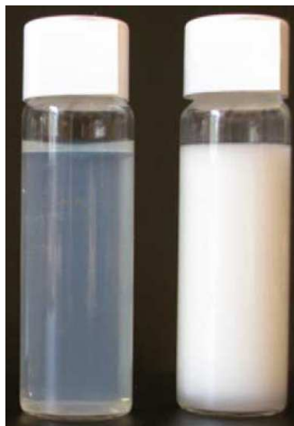
Рис. 44. Внешний вид наноэмульсии (слева) с размером мицелл 35 нм и макроэмульсии (справа) с размером мицелл 1 мкм. (С. Solans, P. Izquierdo, J. Nolla, N. Azemar, M.J. Garcia-Celma. Nano-emulsions // Current Opinion in Colloid & Interface Science. 2005. Vol.10. p. 102 – 110)
