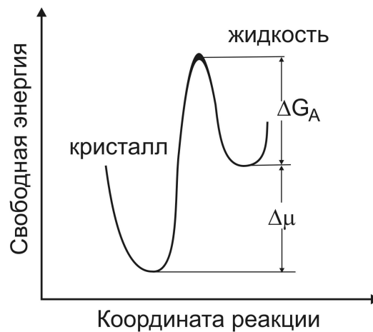
Рис. 9. Изменение свободной энергии частицы при переходе из одной фазы в другую
