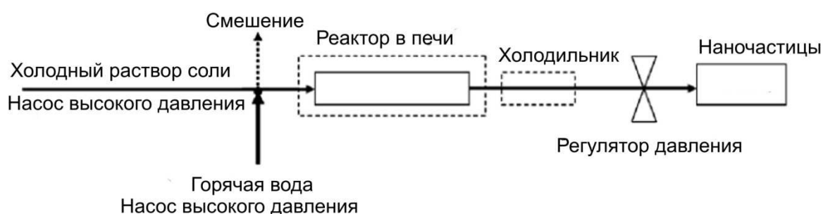
Рис. 78. Схема процесса получения наночастиц оксидов гидротермальным синтезом в сверхкритической воде
