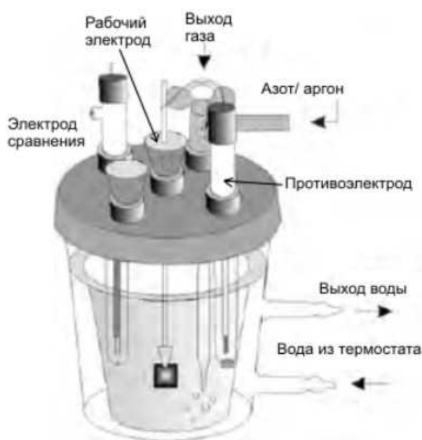
Рис. 109. Ячейка для электроосаждения наночастиц металлов
