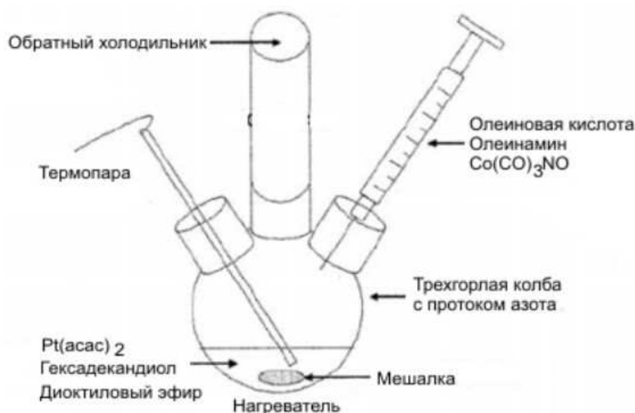
Рис. 105. Схема синтеза наночастиц сплава CoPt восстановлением спиртом
