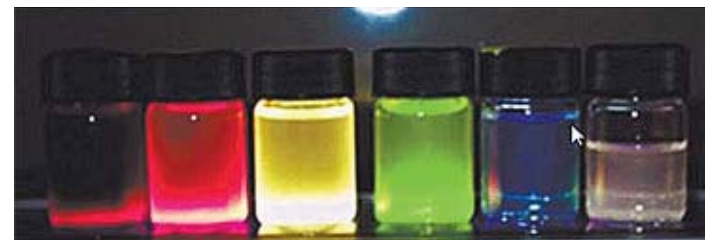
Квантовые точки: разные цвета люминесценции коллоидного раствора квантовых точек селенида кадмия, покрытого олеиновой кислотой, в гептане (Фото: Р.Б. Васильев, А.А. Елисеев (ФНМ МГУ))
