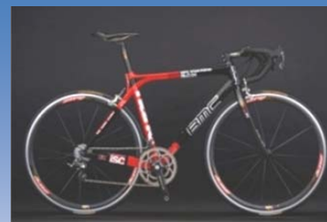
Спортивный велосипед с рамой из композита нанотрубок, имеет массу менее 1 кг.
