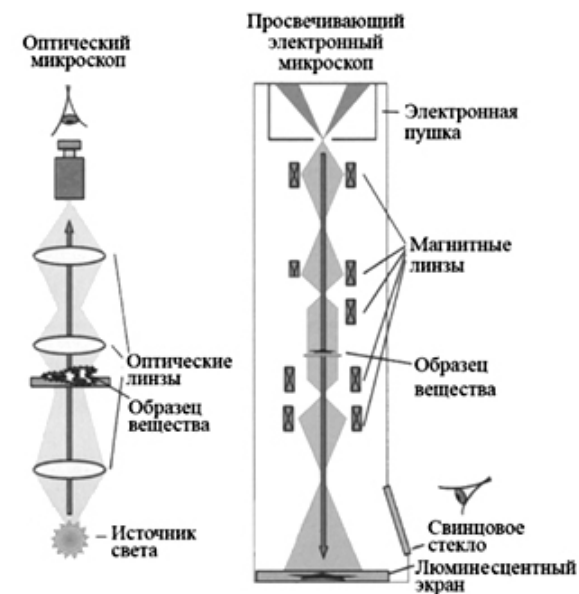
Сравнение оптического и электронного микроскопов (him.1september.ru)
