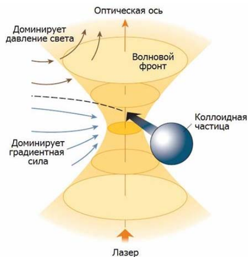
Схема действия оптического пинцета (www.sciam.ru)
